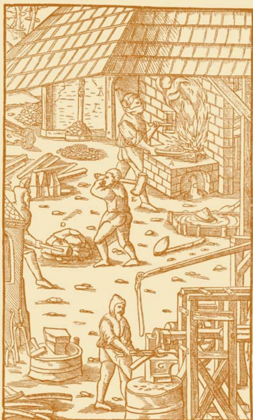
Горн А. Шихта В. Сток шлака С. Железо (крица) D. Деревянные молотки E. Молот F. Наковальня G.
