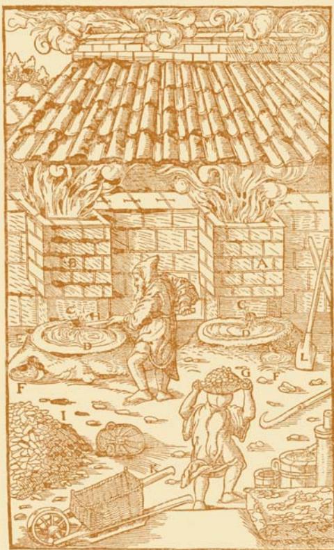
Две печи A, B . Выпускные отверстия C . Передние горны D . Их выпускные отверстия E . Низкие горны F . У печи стоит (подходит к печи) — Пер. ) плавильщик с корзинной древесного угля G . У второй печи стоит плавильщик, разбивающий изогнутым ломом настали, застывшие в выпускном отверстии печи. Изогнутый лом H . Куча древесного угля I . Тачка с корзинной для измерения угля K . Железная лопата L .
