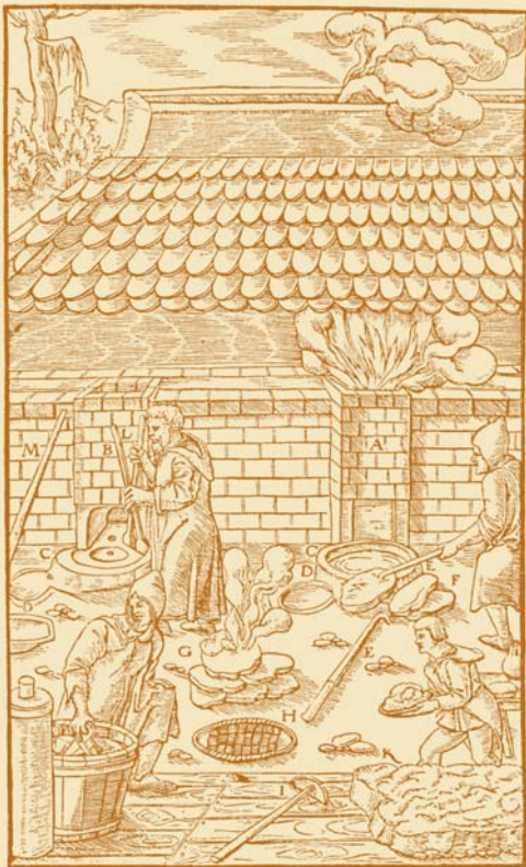
Две печи A, B . Передний горн C . Нижний горн D . Плавильщик, стоя у первой печи, извлекает изогнутым ломом шлаки. Изогнутый лом E . Шлаки F . Помощник черпает ведром воду, которую он выливает на раскаленные шлаки, чтобы потушить их. G . Корзина, сплетенная из прутьев. H . Гребок I . Руда для плавки K . Мастер стоит у второй печи и приготавливает передний горн, утрамбовывая его двумя пестами. Песты L . Лом M .
