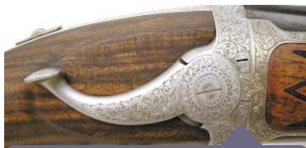
Илл. 7а. Боковой ключ управления для уменьшения усилия, прикладываемого для активации замков, имеет необычные очертания - форму слоновьего хобота
