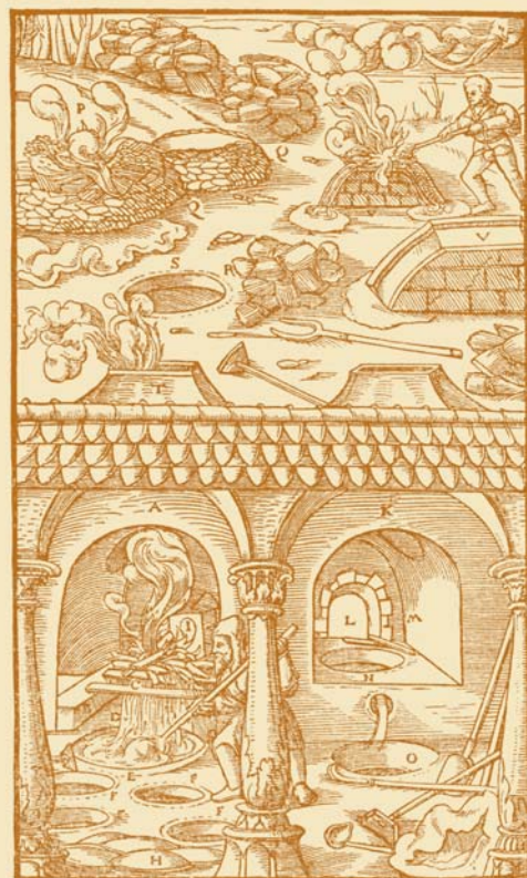
Печь, употребляемая в Каринтии. A . Низкая стена B . Дрова C . Руда, из которой выплавляется свинец. D . Большой тигель E . Малые тигли F . Черпак (ковш) G . Чушки свинца H . Прямоугольное отверстие в задней стенке печи I . Саксонская печь K . Отверстие в задней стенке печи L . Дрова M . Верхний тигель N . Нижний тигель O . Вестфальский способ плавки P . Кучи древесного угля Q . Солома R . Плоские чушки S . Тигли T . Польский горн V .
